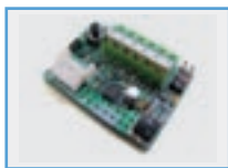
P111408 - SCS WIE Kartica za direktno spajanje dodatne opreme putem wiegand priključaka (npr. SELETTTO, COMPAS SLIM, itd.) na upravljačke jedinice QSC D MA, LIBRA C MA, LIBRA C MV, LIBRA C LX, VENERE D, LEO D MA, LEO MV, RIGEL 5 i ALTAIR P.
