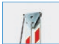
N728010 - ART 180 Uzglobljenje pod 180° za letvu rampe (samo BGV 45-60). Navesti udaljenost između donje i gornje granice traženog prolaza. Smanjuje dužinu letve za 1 m. Letvu je potrebno posebno naručiti.
