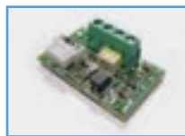
P111376 - SCS 1 Pločica za serijsko spajanje za QSC D MA, LIBRA C MA, LIBRA C MV, LIBRA C LX, VENERE D, LEO D MA, LEO MV, RIGEL 5 i ALTAIR P.
